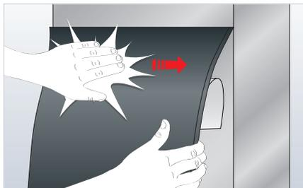
Retirer le film de protection sur environ 10 à 20 cm et aligner la plaque. Presser fermement pour activer l'adhésif.
