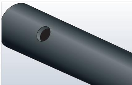
Utiliser des emporte-pièces aiguisés pour réaliser les trous dans les manchons.
