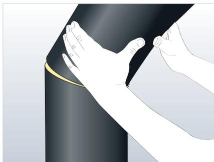
Sur chaque pièce, appliquer de la colle Armaflex sur le joint longitudinal puis l'assembler. Procéder de même pour le joint entre les 2 pièces.
