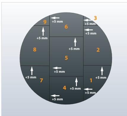
Pour déterminer la forme exacte des plaques constituant l'isolation des bords, marquer les bords de l'Armacell utilisé pour isoler le corps du réservoir à l'aide d'une craie blanche.
