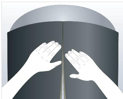
2. Reporter la circonférence sur une plaque d'Armaflex et découper à la taille requise. Étaler une fine couche de colle sur la plaque d'Armaflex puis sur la surface métallique. Lorsque la colle est sèche au toucher (test de l'ongle), positionner la plaque d'Armaflex et presser fermement pour réaliser un bon collage. En fonction de la taille du réservoir, faire dépasser la plaque Armaflex d'environ 10 à 20 cm au-dessus de la soudure du dôme du réservoir.
