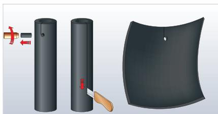
2. Découper un petit trou dans le manchon d'Armaflex à l'aide d'un emporte-pièce afin de faire passer la tige de fixation et découper une fente avec un petit couteau aiguisé le long de la surface plane du manchon.
