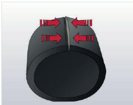
Enrouler le panneau du corps autour des disques de fermeture sans tirer sur l'isolant pendant l'opération. Contrôler l'alignement partout.
