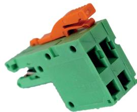
Retirez environ 1 cm d'isolation du câble à l'extrémité des deux câbles d'alimentation et torsadez les fils ensemble. Appuyez maintenant le poinçon fourni dans le trou inférieur droit (donc sous le clip orange), ce qui permet d'insérer le câble + (pos) dans le trou supérieur. Le câble + (pos) est le fil avec la ligne blanche dedans! En tirant le poinçon vers l'arrière, le câble + (pos) est serré. Répétez cette opération pour insérer le câble entièrement noir - (min) sur la gauche.
