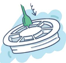
❶ Percez avec une perceuse à spirale ou à bois un trou de Ø 16 mm dans le couvercle du réservoir, de préférence dans le couvercle, pour rendre le nettoyage du noyau cellulaire aussi facile que possible. Vous pouvez également choisir de placer un passage de cuve supplémentaire Ø 60 mm dans lequel ce qui précède peut ensuite être effectué.
