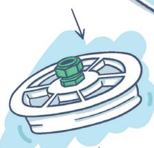
❸ Vissez le passage du couvercle en laiton (A) avec le filetage le plus long dans le couvercle. Le morceau de tuyau en plastique déjà installé dans la partie supérieure du passage du couvercle en laiton empêche le ponçage du câble de raccordement.
