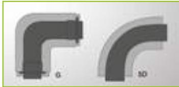
Okapak Coudes, 90 °, une pièce (W) et soudés (W) avec renforcement et Okapak Coudes, 90 ° une pièce (5D), conviennent parfaitement aux raccords longs en fonte trempée conformément à DIN 2605-1, avec une isolation  $\leq 50\text{mm}$ .
