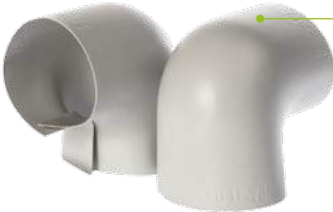
Okapak Coudes, 90 °, une pièce (S) et soudés (S) avec renforcement, conviennent parfaitement aux coudés en acier sans bord conformément à DIN 2605, Norme 3 (1,5 d) et avec une isolation  $\leq 100\text{mm}$ .
